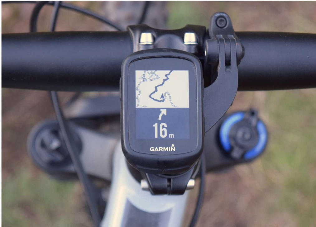
Figura 7: Registro fotográfico com exemplo de navegação por mapa e interface digital de ciclo computador
