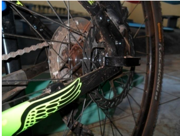
Figura 6 - Roda com blocagem rápida, aros com parede dupla e raios de aço inoxidável
